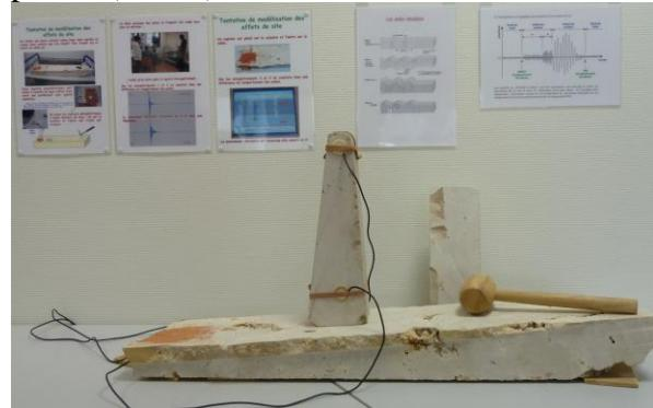
Le matériel, capteurs - câbles - logiciels, a été adapté en vue de mesures des vitesses des ondes effectuées sur le terrain dans divers types de roches lors d'un prochain voyage d'étude géologique dans le parc des volcans d'Auvergne.
